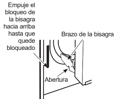
Empuje el bloqueo de la bisagra hacia arriba hasta que quede bloqueado Abertura Brazo de la bisagra Apoye la abertura en el extremo inferior de la ranura de la bisagra
